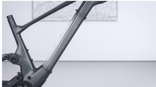
Selbst im Look sieht das SCOTT Lumen eRide einem klassischen Mountainbike zum Verwechseln ähnlich – dank dem clever im Rahmen versteckten Antrieb. Der 250-W-Motor des deutschen Herstellers TQ sorgt für die nötige Power bergauf, ermöglicht ein natürliches Tretgefühl und ist durch die Integration im Bike kaum zu hören. Der dazugehörige 360-Wh-Akku ist ebenfalls unauffällig im Unterrohr verbaut und kann auf besonders langen Touren auch noch mit einem externen Zusatz-Akku ergänzt werden.
